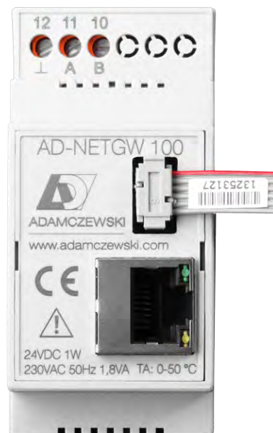
Abbildung 8.1: Firmwareupdate über den AD-UART-Anschluss
