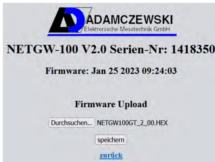
Abbildung 8.2: Firmwareupdate über den LAN-Anschluss
